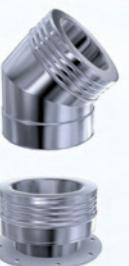
**MKD T** System do agregatów. Charakterystyczna dla systemu jest wytrzymałość na wysoką wartość ciśnienia – do 5000 Pa. Dzięki specjalnym połączeniom elementów na płaszczu, za pomocą silikonu wysokotemperaturowego oraz tzw. swobodnemu rdzeniu, który pod wpływem wysokich temperatur się wydłuża, system doskonale spełnia swoją funkcję przy agregatach najwyższej mocy.
