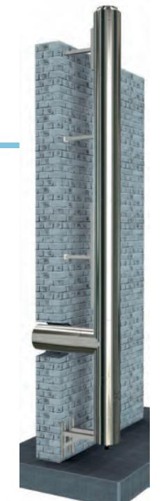
**MKDZ** System dwuścienny, izolowany pogrubioną warstwą izolacji, stosowany, jako samodzielny komin zewnętrzny, do kotłów opalanych paliwem stałym. Pozwala na ustawienie urządzenia grzewczego w dowolnym miejscu w obiekcie, bo komin prowadzi się na zewnątrz, montując go przy ścianie. Występuje w wersji Premium-na paliwa węgiel, drewno, pelet, eko-groszek. System może pracować tylko na sucho w temperaturze do 600°C.
