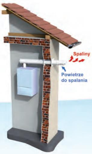
**MKPS** System dwuścienny, bez izolacji, najczęściej stosowany jako przyłącze (wraz z systemem MKKS- jednościennym z uszczelką) lub samodzielny komin, do pieców kondensacyjnych i turbo. Rura wewnętrzna systemu służy odprowadzaniu spalin z kotła, kanał pomiędzy rurą zewnętrzną i wewnętrzną, doprowadza powietrze do kotła. System posiada przetłoczenia pod uszczelki. Występuje w wersji Premium-na paliwa gaz i olej. System może pracować na mokro w temperaturze do 200°C.
